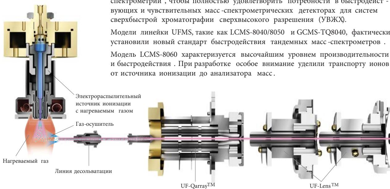
Инновационная система ионной оптики UF-Qarray фокусирует поток ионов и в сочетании с источником ионизации с нагреваемым газом и усовершенствованной системой вакуумирования обеспечивает значительное усиление интенсивности сигналов целевых ионов. При этом интенсивность шума не возрастает и остается на уровне, характерном для предыдущих моделей масс-спектрометров.
