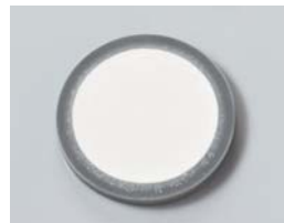
Спрессуйте порошок в таблетку с помощью пресса (метод прессования)
