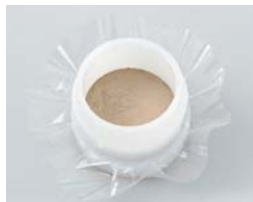
Закрепите на дне кюветы пленку и насыпьте образец (метод свободной засыпки)
